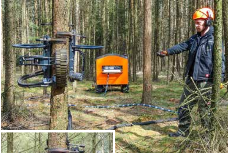
Entastungskopf, Antriebs- und Transporteinheit mit Verbrennungsmotor und hydraulischem Raupen-Fahrtrieb. Die Steuerung erfolgt elektrisch über Funkfernbedienung.
