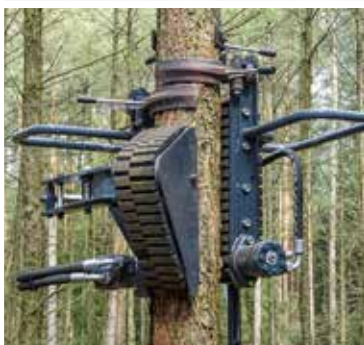
Entastungskopf, Antriebs- und Transporteinheit mit Verbrennungsmotor und hydraulischem Raupen-Fahrtrieb. Die Steuerung erfolgt elektrisch über Funkfernbedienung.
