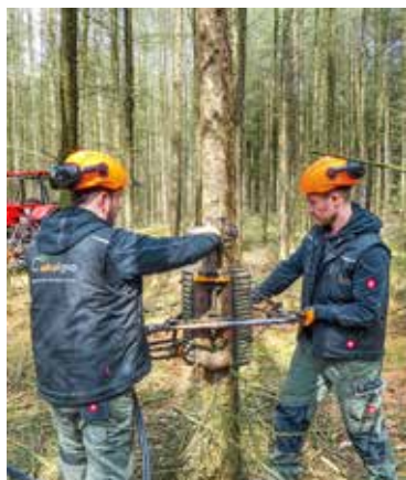
Der Entastungskopf, hier der Prototyp, wiegt etwa 45 kg und kann durch ein Trägerfahrzeug oder von zwei Personen auch manuell umgesetzt werden.
