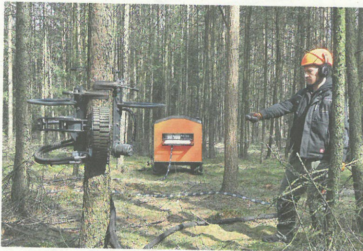
Entastungskopf, Antriebs- und Transporteinheit mit Verbrennungsmotor und hydraulischem Raupen-Fahrertrieb. Die Steuerung erfolgt elektrisch über eine Funkfernbedienung.
