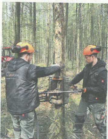
Der Prototyp des Entastungskopfes wiegt etwa 45 kg und kann durch ein Trägerfahrzeug oder von zwei Personen umgesetzt werden.
