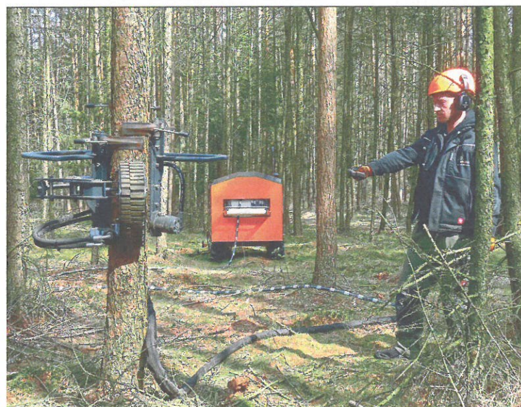
Die Technik besteht aus dem Entastungskopf sowie der Antriebs- und Transporteinheit mit Verbrennungsmotor und hydraulischem Raupen- antrieb. Die Steuerung erfolgt elektrisch über Funkfernbedienung.
