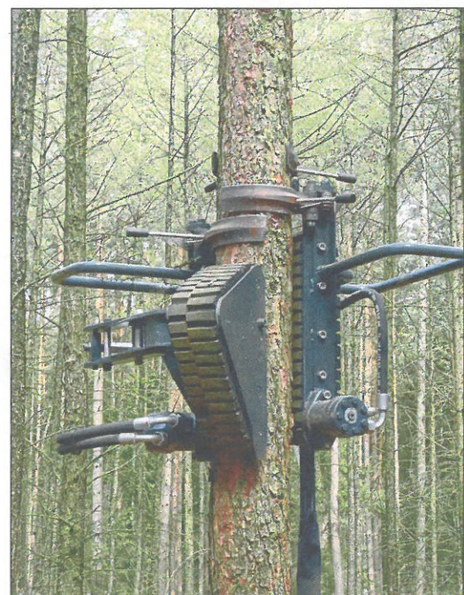
Der Schneidekopf wird hydraulisch angetrie- ben. Der Druck der Gummilaufbänder auf die Rinde ist minimal und verhindert Beschädigun- gen des Baums.
